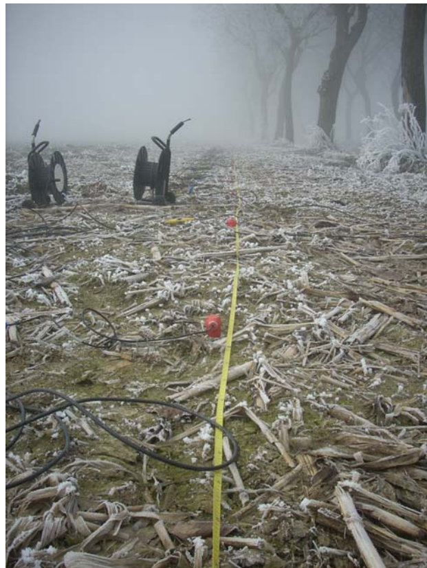
Figura 6 Stendimento di geofoni
