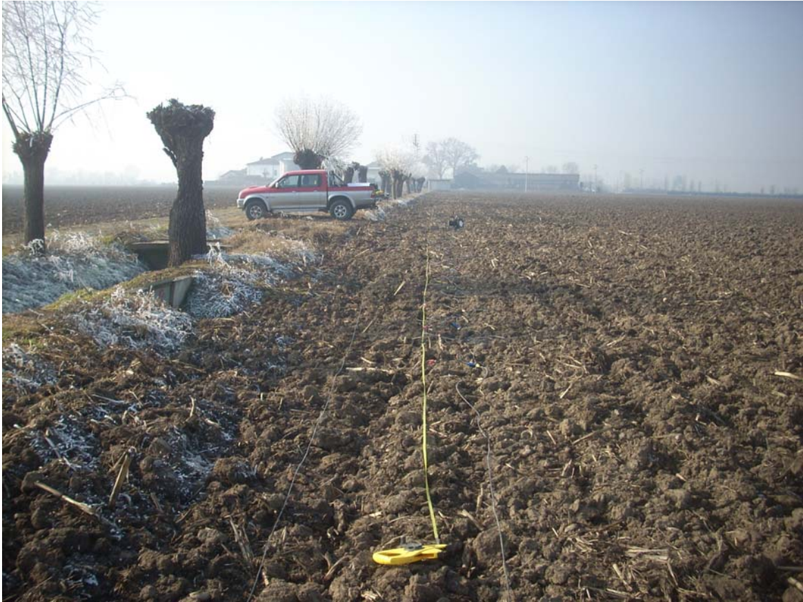
Stendimento di geofoni verticali
