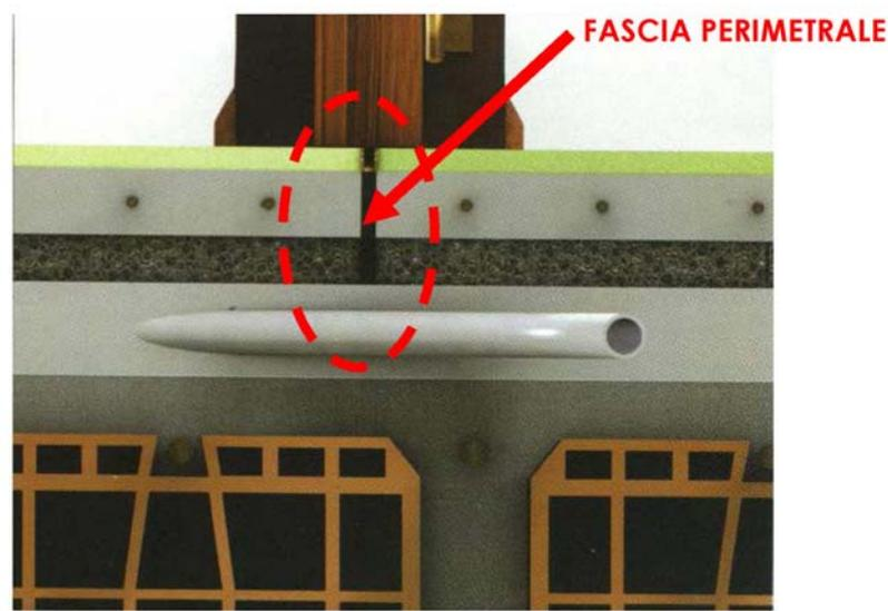
Figura 3-14 - Posizionamento della fascia perimetrale che si consiglia di adottare in corrispondenza
