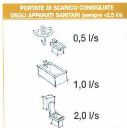
**Figura 3-4** - Indicazione delle portate di scarico consigliate degli apparati di scarico.
