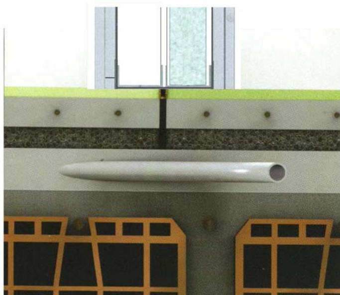
**Figura 3-17** - Schema della sconnessione in corrispondenza dei punti in cui saranno realizzati i tramezzi in cartongesso.
